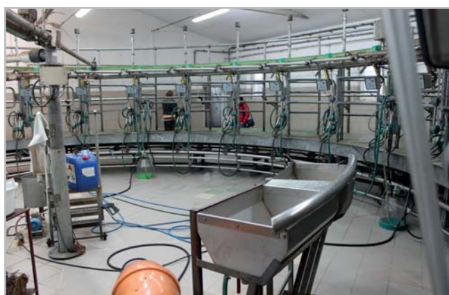
Kruhová dojírna je vybavena nerezovou mezidezinfekční vanou, která se při dojení přisune k jejímu okraji tak, aby byla dostupná pro desinfekci jednotlivých strojů Foto Jana Velechovská
