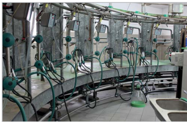
Součástí kruhu jsou i drážky dojícních strojů, které minimalizují jejich poškození a ztráty podtlaku Foto Jana Velechovská
